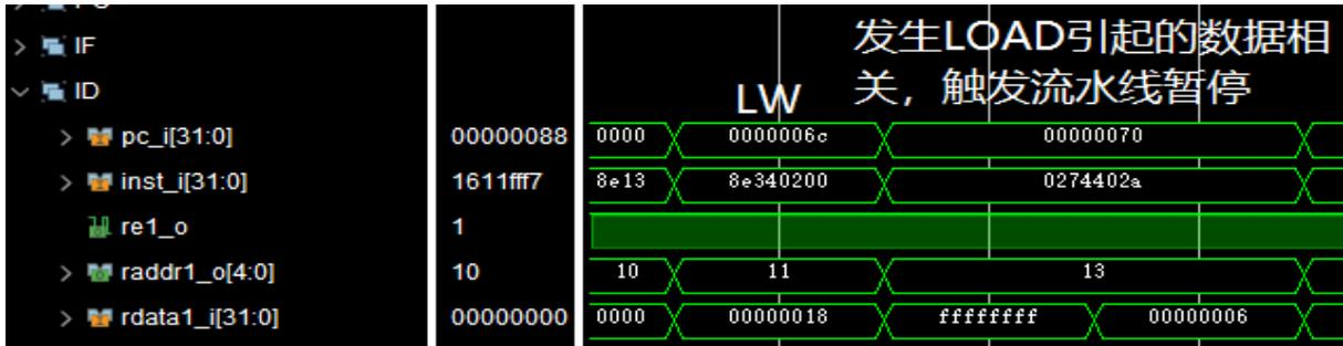
上图展示了 CPU 如何解决 LOAD 指令引起的数据相关。在后面发生数据相关时，0x70 处的指令在 ID 阶段发起了流水线暂停，使得在波形图上该指令占了两拍。
