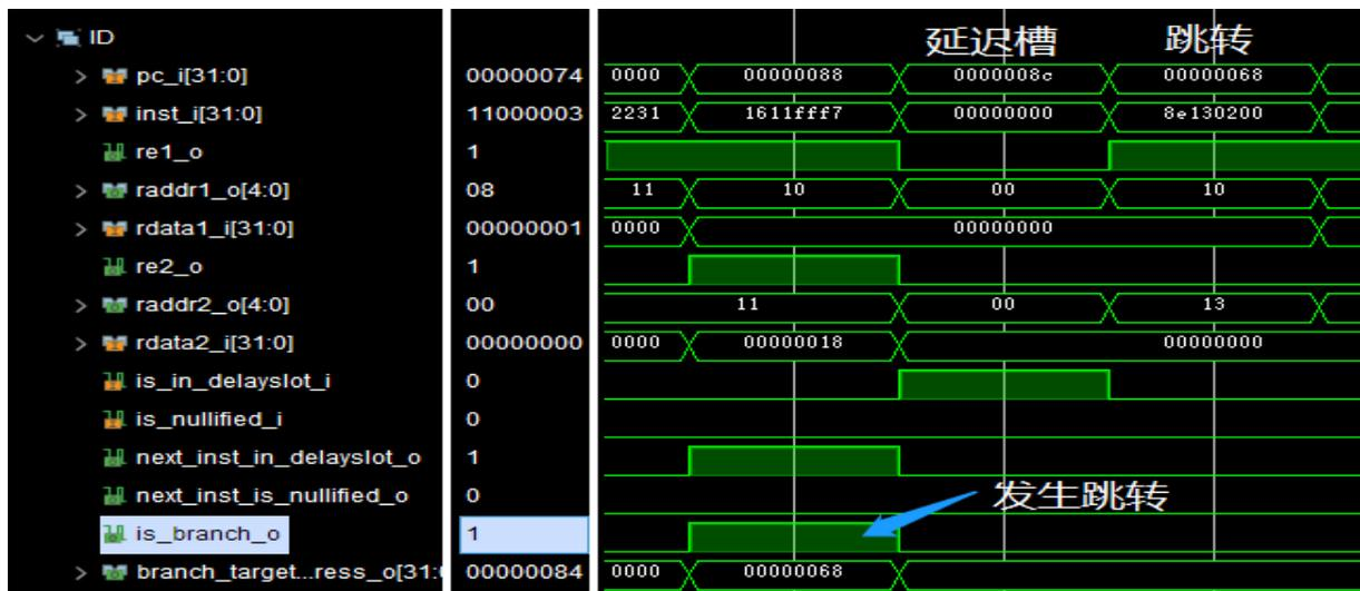
上图展示了 CPU 在处理跳转时的延迟槽特性。0x88 处发生跳转，0x8c 成为延迟槽，随后便执行转移后的 0x68 处的指令。
