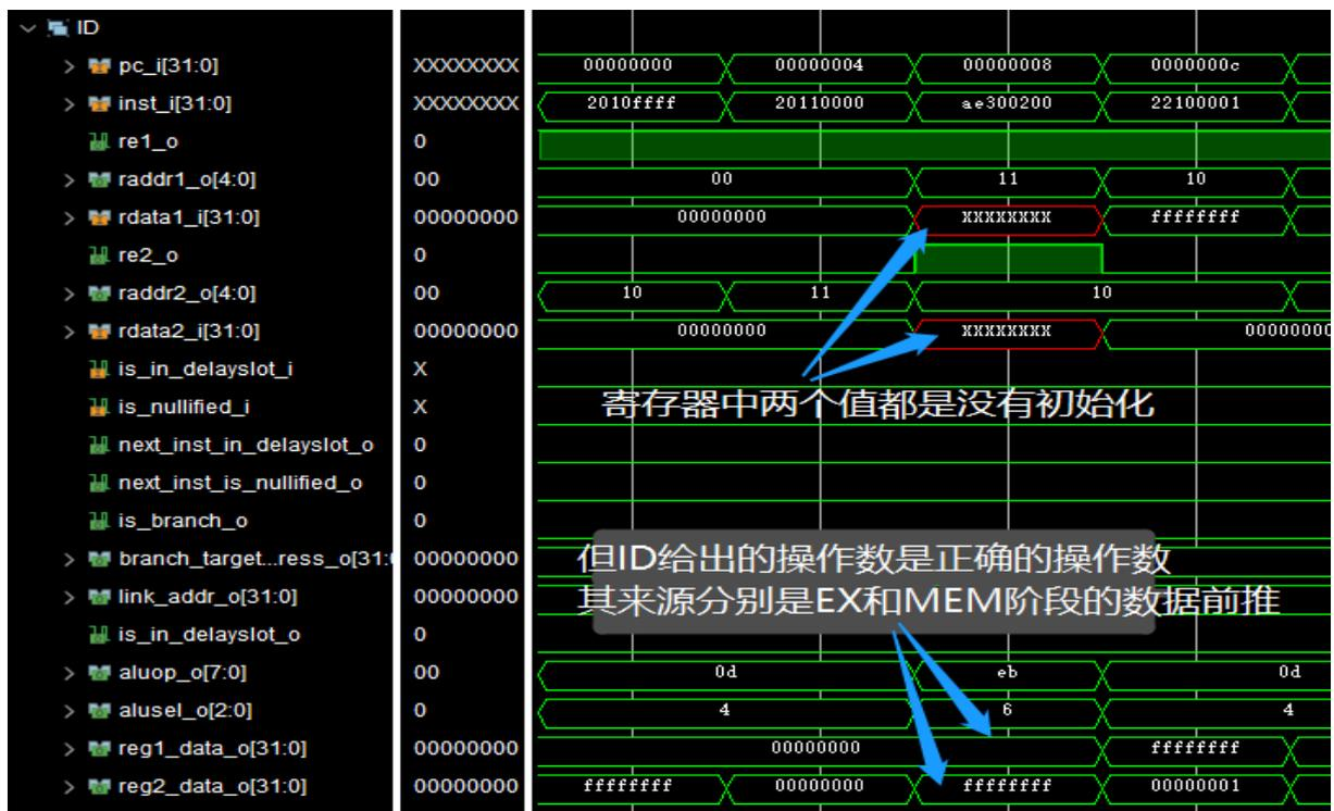
上图中展示了解决数据相关问题的波形图：第三条指令同时用到了 s0 和 s1 寄存器，而二者在寄存器堆中还未初始化，说明前面两条指令的运算结果还未写回，而下方 ID 阶段给出的操作数是正确的，说明 ID 模块利用数据前推解决了数据相关问题。
